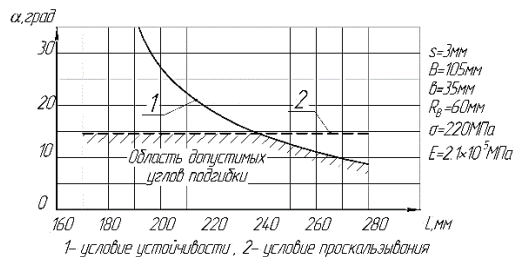
Рис. 4. Зависимость максимально допустимого угла подгибки от межклетьевого расстояния
