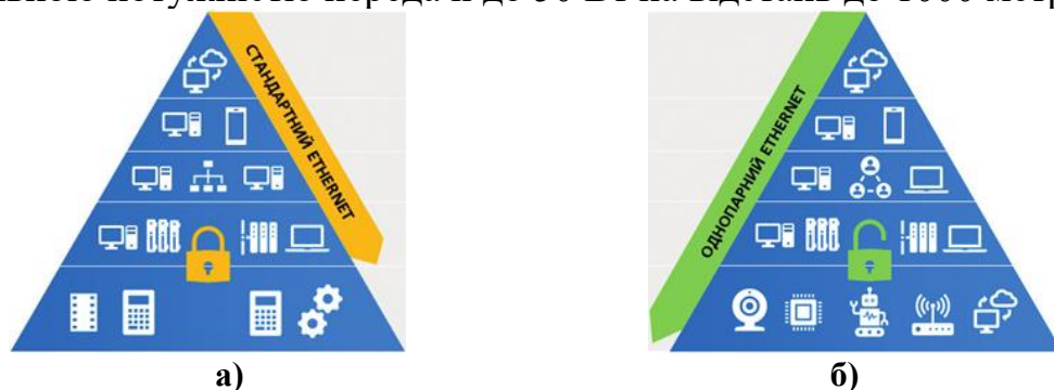
Рис. 1 – Технологія промислового Ethernet на базі витих пар: 4-х (а) та однієї (б)
