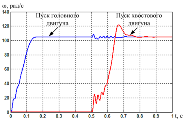
Рисунок 2 – Швидкості головних та хвостових асинхронних двигунів при послідовному пуску
